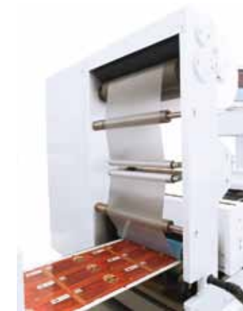
Módulo de plastificado con cuerpo flexográfico (linerless).
