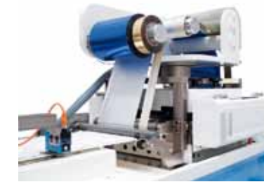
Modules à plat de dorure et gaufrage.
