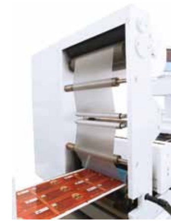
Module de pelliculage linerless avec poste flexo.
