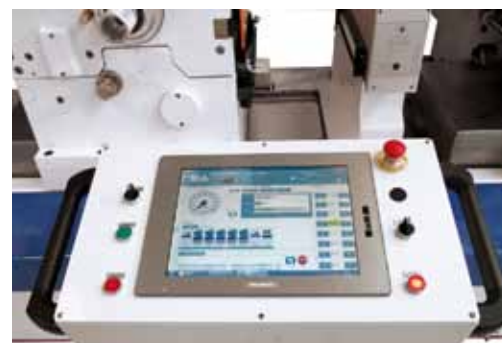
Écran tactile de contrôle déplaçable.
