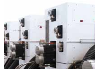
Poste Offset 100% servomotorisé.
