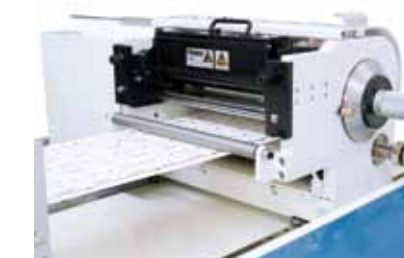
Poste d'impression / vernissage flexo.
